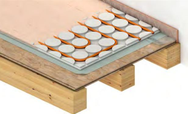
› Durchbiegung, Ebenflächigkeit und Tragfähigkeit überprüfen (siehe z. B. max. Verformung  $V_m$ , Tabelle Kap. 3.1), falls erforderlich Konstruktion verstärken
